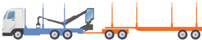
Figur 6. Schablonbild över ett 7-axligt kranfordon med egen kran (von Hofsten, 2019).
