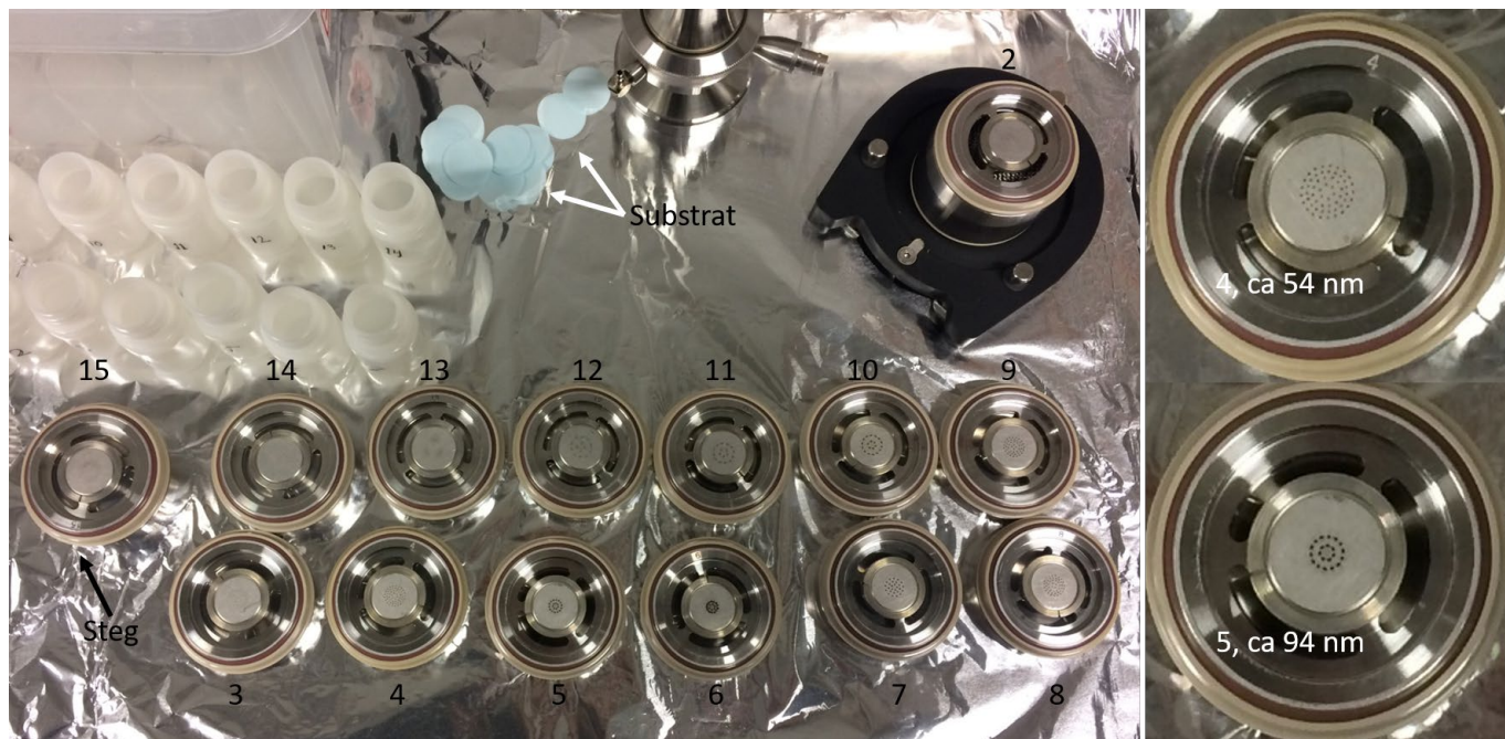
Figur 16 Steg (2 - 15 med förstoring av 4 - 5) och substrat från inledande körningar under slutet av november. Steget med det lägsta numret samlar in de minsta partiklarna och det största de största.
