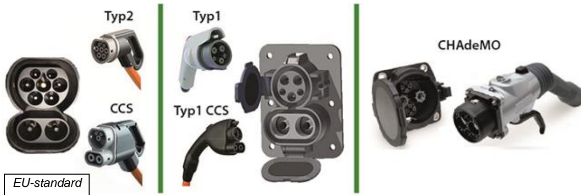
Figur 5.3 Fyra kontakter som kan förekomma på en elbil. Typ 1 och 2 är för normalladdning med växelström, medan CHAdeMO och CCS är för snabbladdning med likström. (chargestorm.se, 2021)
